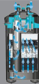
Схема движения и фильтрации воды
